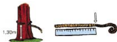
Figura 18 – Para calcular o perímetro de uma árvore, rodeá-la com uma corda (a cerca de 1,30m do chão) e marcar o sítio em que as pontas se unem. Estender a corda e medir com a régua o comprimento até ao ponto marcado (fonte: DGRF, Caderno da floresta, 2005)
