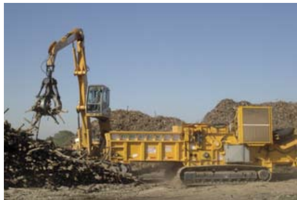
Imagem 26 – Transformação de resíduos de exploração florestal em estilha para aproveitamento energético
